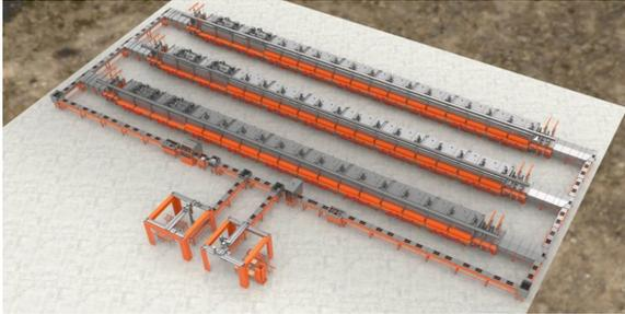
Figure 15 : Gazettes placées sur des convoyeurs menant à trois fours tunnels (Source : Therser UK)
